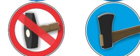
7. Drátěné lano je potřeba odseknout jedině se zadní částí sekery.
