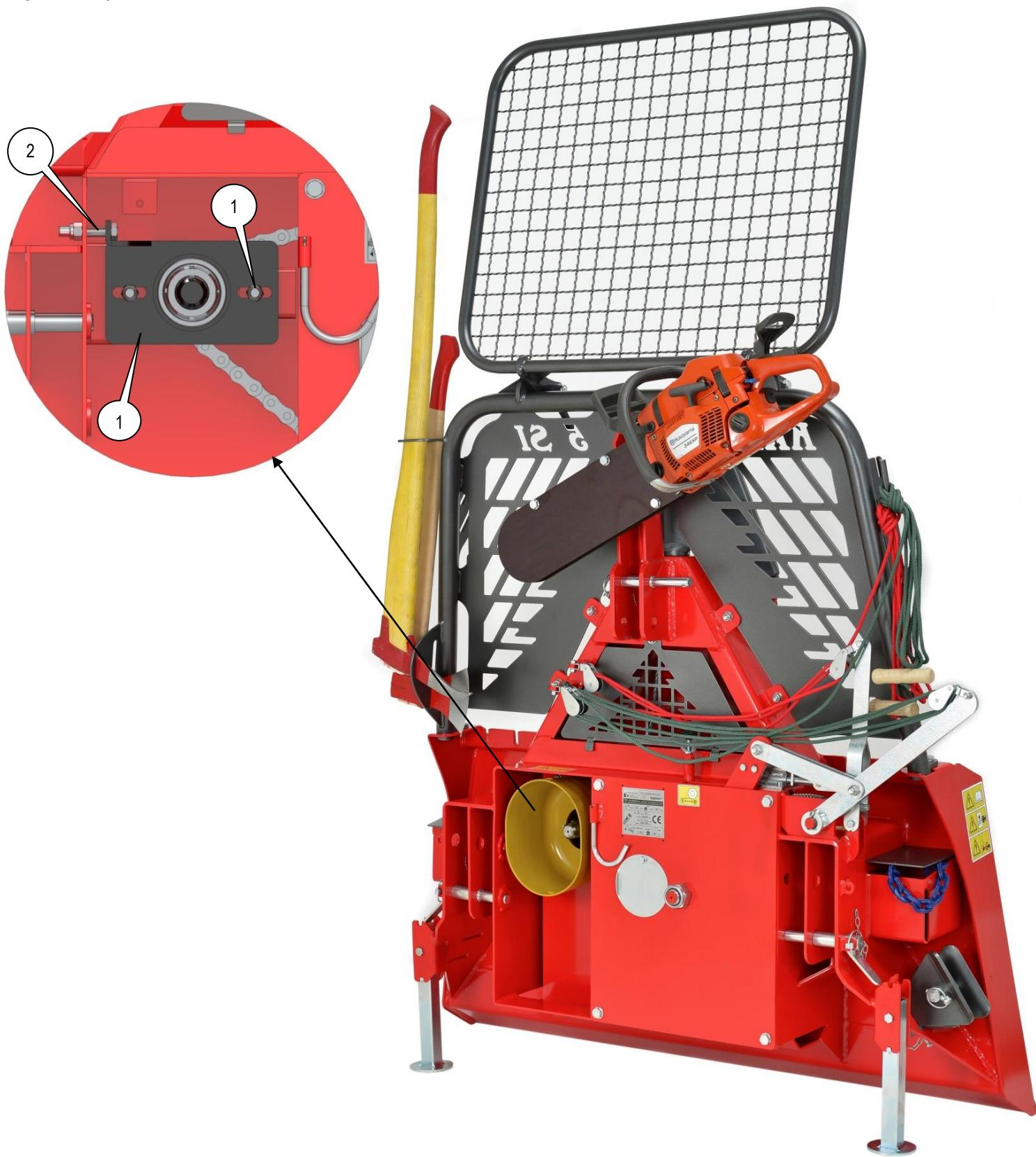
Řetězy namažte vhodným mazivem (lithiovým), které je maximálně přilnavé, aby během provozu neodpadávalo. Existuje totiž nebezpečí, že by se odpadávající mazivo dostávalo na lamelu spojky, čímž by se zmenšila vlečná síla. Mazivo musí být také vodovzdorné a odolné proti teplotám v rozsahu od -25 stupňů do +125 stupňů Celsia. Pro mazání řetězu se může použít také sprej podobných vlastností.
