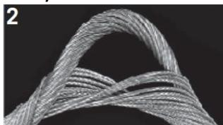
Kvůli rotaci (zkroucení) ve směru otáčení ocelového lana se „nekroutitivé“ ocelové lano zkrátilo a jádro prodloužilo.
