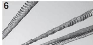
Ocelová lana se formují do tvaru vrtáku, protože se ocelové lano dřelo o části konstrukce, nebo se vleklo skrze příliš úzké drážky.
