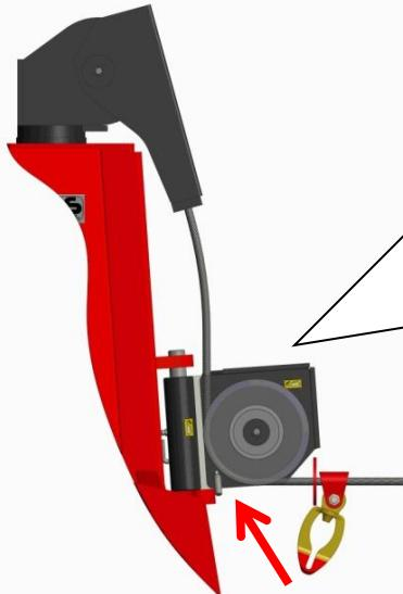
Při vlečení přes spodní kladku nesmí omezovací obklady nebo posuvníky nataženy do spodní kladky, v opačném případě může dojít k poškození lana.
