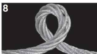
Toto lano se zkroutilo ve směru otevírání (odvijení) ocelového lana. V nezatiženém stavu tvoří smyčku ve směru otáčení lana. Po zatižení lana se snyčka utáhne a může trvale změnit tvar lana.
