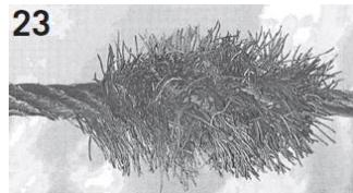
Brzdové lano jeřábu s držadlem. Všechny vnější dráty jsou vlivem opotřebování na výstupní hubici 1x na délku plétení polámány. Zlomené části se potom mačkaly do konečného bodu posunu.
