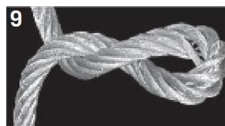
Toto lano se zkroutilo ve směru otáčení lana. V nezatiženém stavu tvoří snyčku ve směru odvijení lana.
