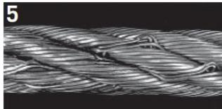
Na tomto šestí pramenném laně se kvůli kroucení povolily vnější vrstvy drátů vnějších pramenů.
