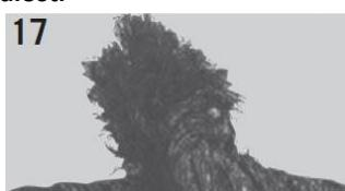
Při zatižení vzniklých snyček dojde k zlomení vláken a deformacím.
