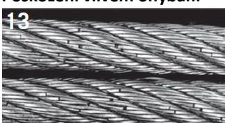
Zlámání drátů na ocelových lanech se zavřenými prameny způsobené vyčerpáním.
