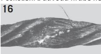
Zploštění z důvodu mačkání. Poškození jsou trvalá.
