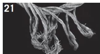
Toto lano se zcela rozevřelo. Vnější prameny jsou pro ocelové lano příliš dlouhé. Tam, kde kladkostroj tlačil na přebytečné prodloužení, stojí prameny zpříma.
