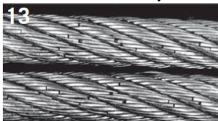
13 Zlámání drátů na ocelových lanech se zavřenými prameny způsobené vyčerpáním.
