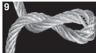
9 Toto lano se zkroutilo ve směru otáčení lana. V nezátíženém stavu tvoří smyčku ve směru odvíjení lana.
