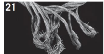
21 Toto lano se zcela rozvinulo. Vnější prameny jsou pro ocelové lano příliš dlouhé. Tam, kde kladkostroj tlačil na přebytečně prodloužení, stojí prameny zpřímá.
