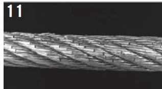
11 Ještě jeden příklad lana vedeného příliš úzkým kladkostrojem.
