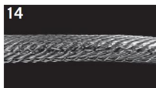
14 Toto nekroutivé ocelové lano bylo taženo přes okraj kladkostroje, a tím se hodně poškodilo.
