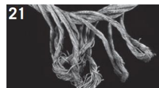
21 Toto lano se zcela rozvinulo. Vnější prameny jsou pro ocelové lano příliš dlouhé. Tam, kde kladkostroj tlačil na přebytečné prodloužení, stojí prameny zpřima.
