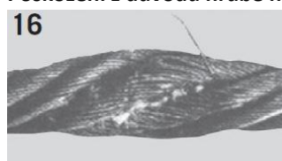
16 Zploštění z důvodu mačkání. Poškození jsou trvalá.
