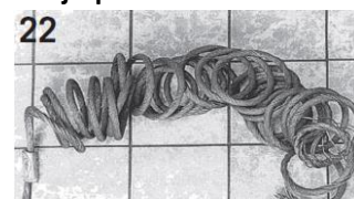
22 Pokud se ocelové lano táhne přes ostré hrany, má sklon se v nezátíženém stavu navíjet.
