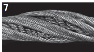
7 Kvůli kroucení lana o kladkostroj se prameny v jádře lana přebytečně prodloužily. Taková poškození se mnohokrát nachází na koncích pohybu lana, které je vedeno přes kladkostroje nebo bubny.
