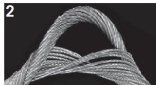
2 Kvůli rotaci (zkroucení) ve směru otáčení ocelového lana se „nekroutivé“ ocelové lano zkrátilo a jádro prodloužilo.
