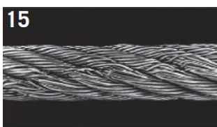
15 Toto lano bylo taženo přes okraj kladkostroje. Všimněte si stopy poškození.
