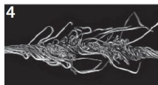
4 Časté kroucení ovlivňuje jenom vnitřní (nejkratší) pramen. Ten jediný leží natažený na ocelovém laně.
