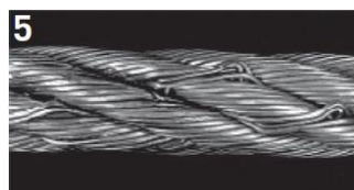
5 Na tomto šesti prameném laně se kvůli kroucení povolily vnější vrstvy drátů vnějších pramenů.
