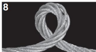
8 Toto lano se zkroutilo ve směru otevírání (odvíjení) ocelového lana. V nezátíženém stavu tvoří smyčku ve směru otáčení lana. Po zatížení lana se smyčka utáhne a může trvale změnit tvar lana.
