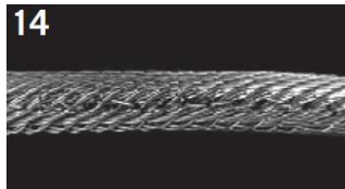
14 Toto nekroutivé ocelové lano bylo taženo přes okraj kladkostroje, a tím se hodně poškodilo.
