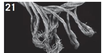
21 Toto lano se zcela rozvinulo. Vnější prameny jsou pro ocelové lano příliš dlouhé. Tam, kde kladkostroj tlačil na přebytečně prodloužení, stojí prameny zpříma.
