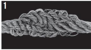
1 Ocelové lano po „oloupání“ vnějších pramenů. Dobře viditelné hromadění přebytečných délek
