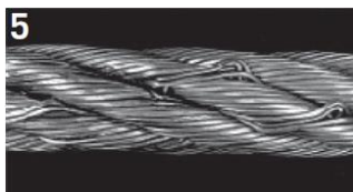
5 Na tomto šesti pramenném laně se kvůli kroucení povolily vnější vrstvy drátů vnějších pramenů.
