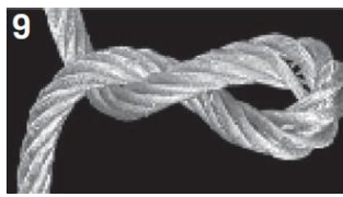
9 Toto lano se zkroutilo ve směru otáčení lana. V nezatiženém stavu tvoří smyčku ve směru odvíjení lana.
