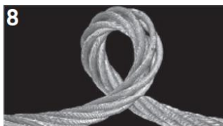
8 Toto lano se zkroutilo ve směru otevírání (odvíjení) ocelového lana. V nezatiženém stavu tvoří smyčku ve směru otáčení lana. Po zatížení lana se smyčka utáhne a může trvale změnit tvar lana.
