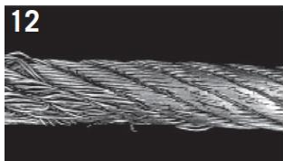
12 Příliš široký kladkostroj špatně podepírá ocelové lano. Následkem je rychlé zlámání drátů na styčném povrchu.
