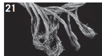
21 Toto lano se zcela rozvinulo. Vnější prameny jsou pro ocelové lano příliš dlouhé. Tam, kde kladkostroj tlačil na přebytečné prodloužení, stojí prameny zpříma.
