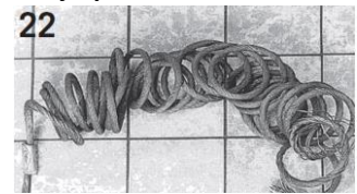
22 Pokud se ocelové lano táhne přes ostré hrany, má sklon se v nezatiženém stavu navíjet.
