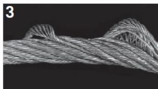
3 Ocelová lana s dvojitým souběžným navinutím pramenů jsou citlivá na zkroucení. Zde došlo k prodloužení vnitřních pramenů, což je vytlačilo ven.
