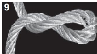
9 Toto lano se zkroutilo ve směru otáčení lana. V nezatíženém stavu tvoří smyčku ve směru odvíjení lana.
