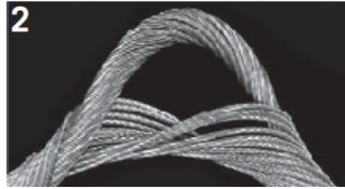
2 Kvůli rotaci (zkroutení) ve směru otáčení ocelového lana se „nekrouťivé“ ocelové lano zkrátilo a jádro prodloužilo.
