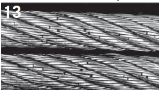
13 Zlámání drátů na ocelových lanech se zavřenými prameny způsobené vyčerpáním.
