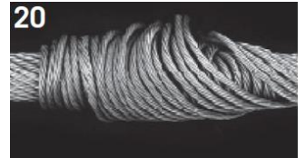
20 Ještě jedno vytvoření košíku na nekrouťivém laně.
