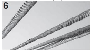
6 Ocelová lana se formují do tvaru vrtáku, protože se ocelové lano dělo o části konstrukce, nebo se vleklo skrze příliš úzké drážky.
