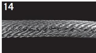
14 Toto nekrouťivé ocelové lano bylo taženo přes okraj kladkostroje, a tím se hodně poškodilo.
