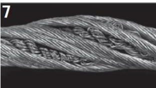
7 Kvůli kroucení lana o kladkostroj se prameny v jádře lana přebytečně prodloužily. Taková poškození se mnohokrát nachází na koncích pohybu lana, které je vedeno přes kladkostroje nebo bubny.
