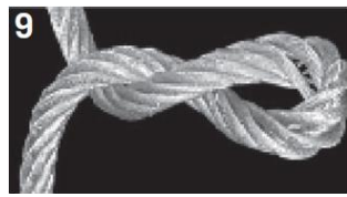
9 Toto lano se zkroutilo ve směru otáčení lana. V nezátíženém stavu tvoří smyčku ve směru odvíjení lana.
