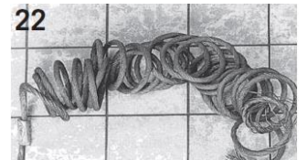
22 Pokud se ocelové lano táhne přes ostré hrany, má sklon se v nezátíženém stavu navíjet.
