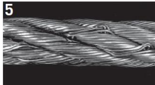
5 Na tomto šesti pramenném laně se kvůli kroucení povolí vnější vrstvy drátů vnějších pramenů.
